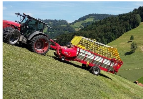
Pöttinger Ladewagen mit Hilfstriebachse
