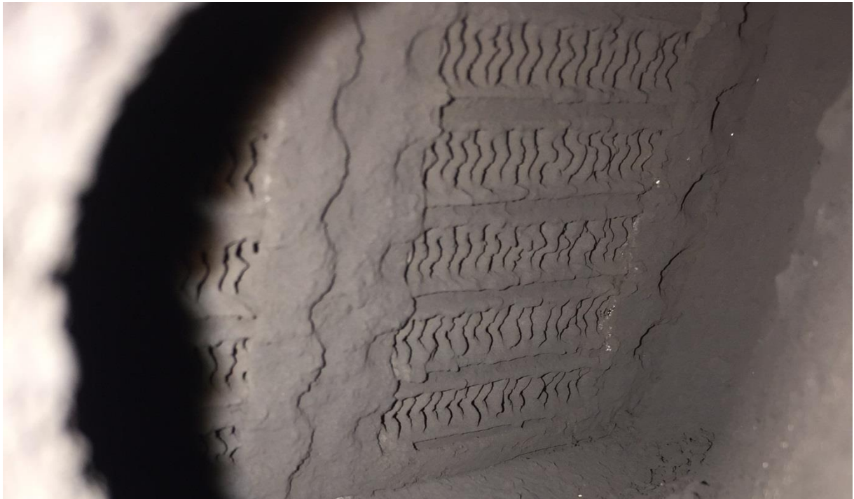
Abbildung 39: Ablagerungen im AGR-Kühler des John Deere 6210R (JD-P)
