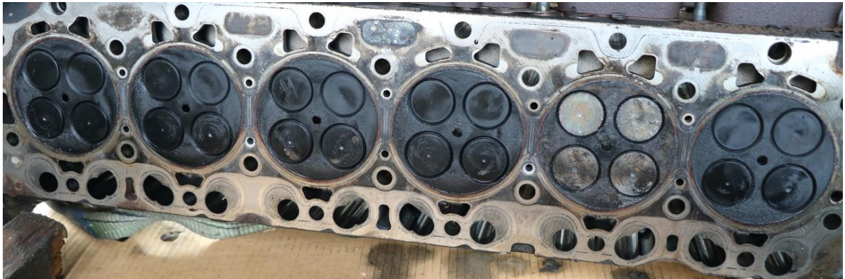
Abbildung 21: Zylinderkopf des Traktors DE-N bei 3.500 Bh unmittelbar nach einem Motorschaden (Reihenfolge 1–6, von rechts nach links)
