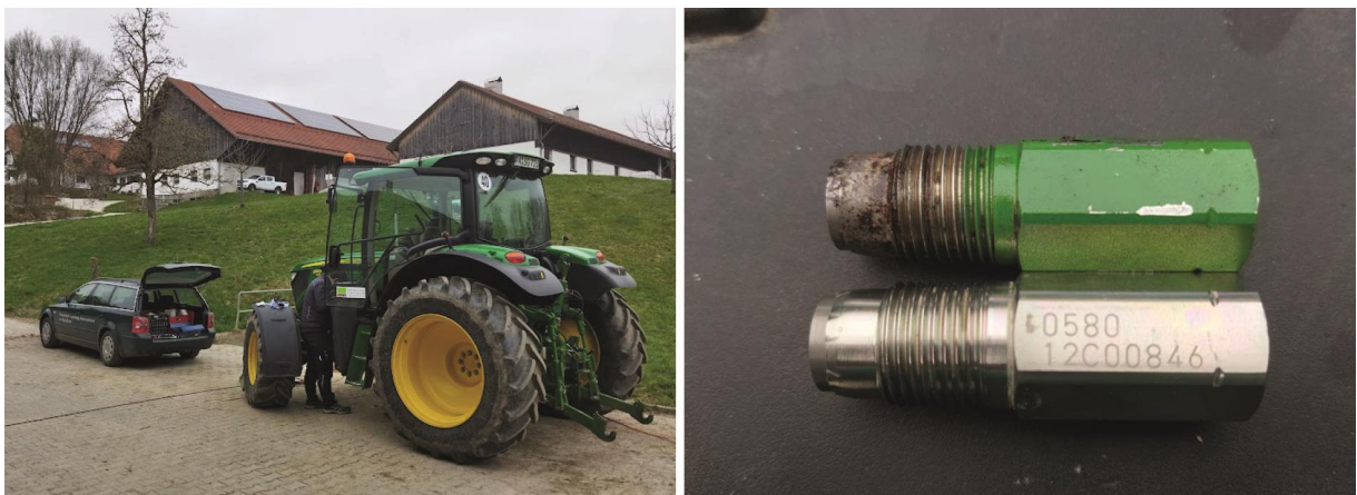
Abbildung 17: Fehlersuche am Traktor JD6R-B (links) und Überdruckventil an der Common-Rail-Hochdruckeinspritzung (rechts)
