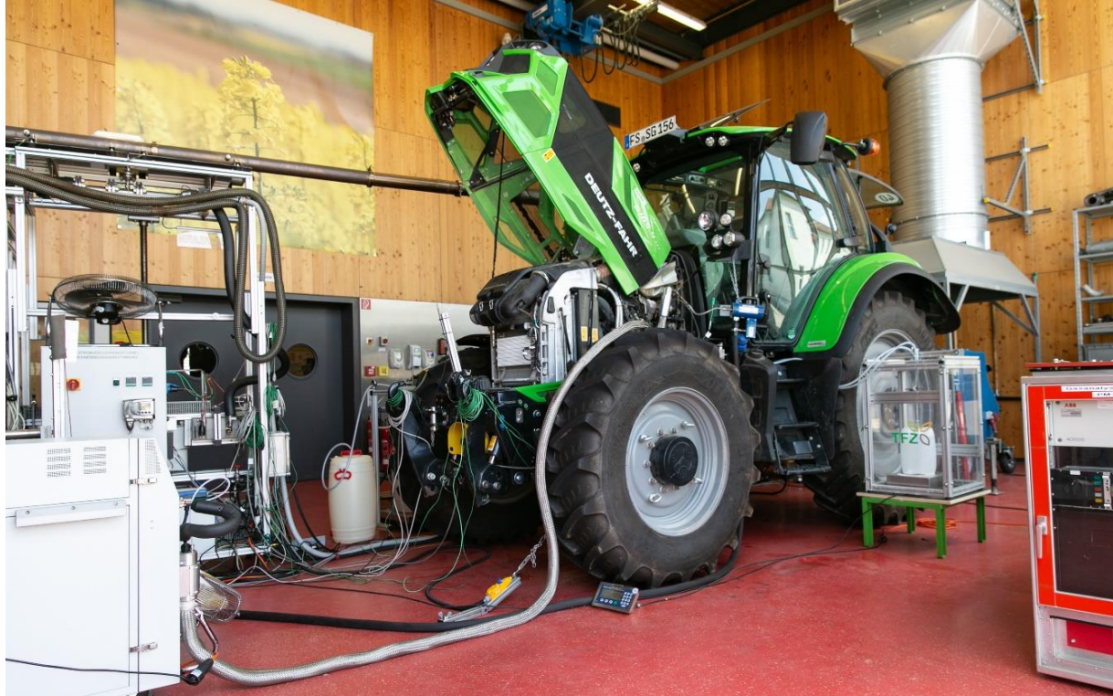
Abbildung 11: Deutz-Fahr 6165.4 TTV (DE-F) mit einem Zwei-Tank-System der Fa. bioltec am Traktorenprüfstand
