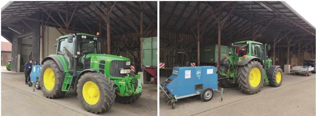
Abbildung 16: Leistungsmessung am John Deere 6930 Premium
