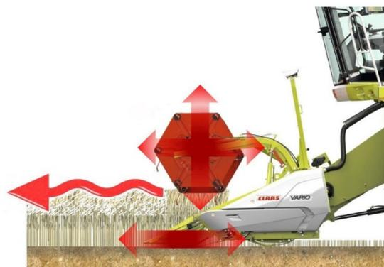
débit de battage dues à un flux de récolte irrégulier. En outre, les correcteurs de réglage ne peuvent pas optimiser les réglages de la machine de manière ciblée si une erreur de réglage est déjà présente au niveau de la barre de coupe.
